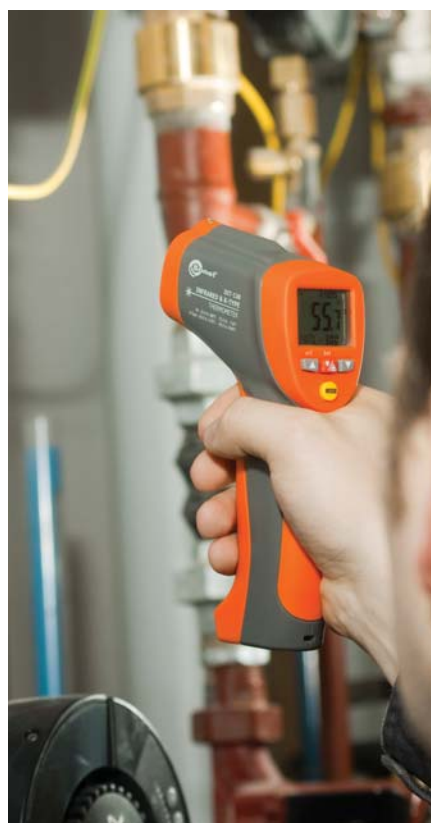
Rys. 1. Pomiar temperatury pirometrem
